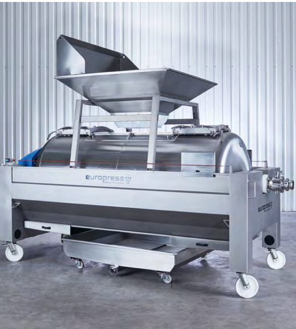
Die Europress-Traubenpresse bietet drei verschiedene Press-Systeme und zahlreiche Presskorbgrößen. Foto: Scharfenberger
