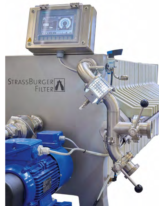
Strassburger Filter hat seinen Kammerfilter mit Touch-Display und SPS-Steuerung ausgestattet. Foto: Strassburger Filter
