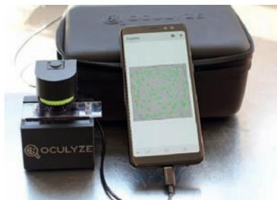
Abb. 1: Angeschlossen an ein handelsübliches Smartphone kann das Smartphone-Mikroskop der Firma Oculyze (Oculyze FW) mit Hilfe einer App die Zellzahl und Viabilität einer Probe analysieren.
