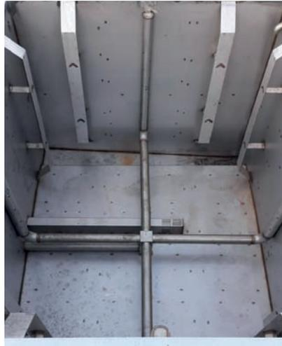
Abb. 3: Tauchbehälter mit Strömungskanälen. Für die phytosanitäre Wirkung ist eine ständige Durchströmung des Rebenpflanzgutes mit Heißwasser konstanter Temperatur erforderlich.
