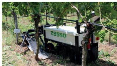
Abb. 3: Handgeführtes Versuchsgerät der Fa. Zasso - die beiden Applikatoren ermöglichen den Stromfluss durch die Pflanzen.
