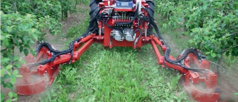
Abb. 2: Zweiseitig arbeitendes Bodenbearbeitungsgerät
