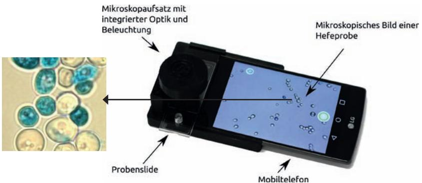
Abb. 1: Bestimmung der Lebendzellzahlen im Wein mit Hilfe des Smartphone-Mikroskopes. Durch Zugabe von Methylblau werden vor der Messung tote Zellen angefärbt. Die Bestimmung der LZZ erfolgt anschließend über das Smartphone mittels einer integrierten Auswertesoftware.
