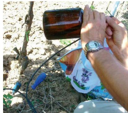
Abb. 1: Links: Saugkerze in einem Kunststoff-Schutzschacht mit Sammelflaschen für Sickerwasser aus unterschiedlicher Tiefe. Rechts: Entnahme und Analyse einer Sickerwasserprobe
