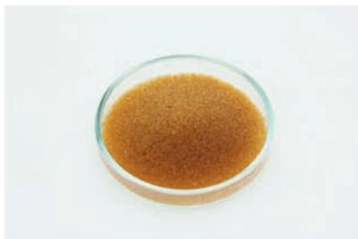
Abb. 1: Eine Kationenaustauscherkartusche mit einem Volumen von 30 L (oben) reicht zur Behandlung von etwa 1000 L Most oder Wein. Das Füllmaterial besteht aus 0,6 mm großen Perlen aus Kunstharz (unteres Bild).
