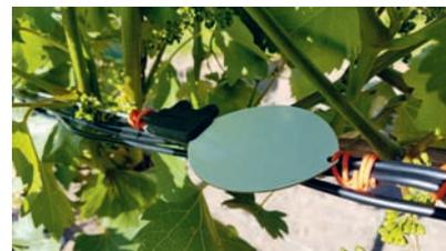
Abb. 2: Montage der Datalogger, Blattnässe-Sensoren und des Ventilators in der Rebfläche.
