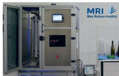
Abb. 1: UV C Pilotanlage zur Behandlung von Wein
