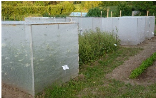
Käfigkonstruktion mit Insektenschutznetz
